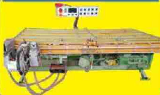
استند مونتاژ عمودی با قابلیت لیفت اتوماتیک اوریان ابعاد cm 1500 \times cm 3000
