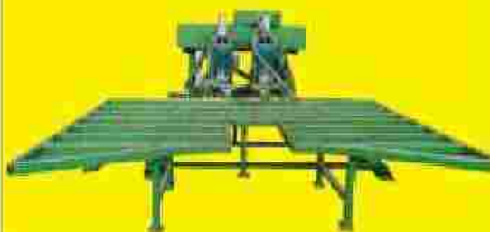
استند دروازه‌ای عمودی پنوماتیک اوریان با قابلیت لیفت cm 2500 \times cm 4000
