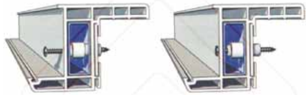
شکل ۱۱ جزئیات قرارگیری مهره تثبیت کننده در پروفیل
