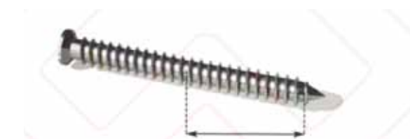
شکل ۱۹ نمونه پیچ بدون نیاز به رول پلاگ برای درگیری حداقل ۴۰ میلی متر در داخل بتن
