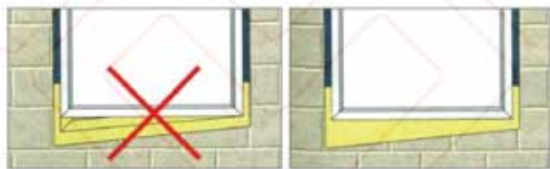
شکل ۱۰ نمونه روش مناسب (تغییر ضخامت درزبند) و نامناسب (ضخامت ثابت و ناکافی درزبند)
