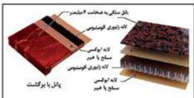
شکل ۶- پانل لانه زنبوری-سنگ که در آن لبه پانل فرم داده شده است
