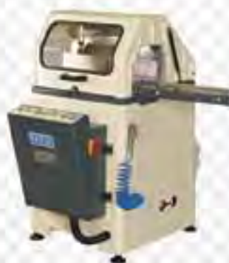
برش یک سر ہلومائیک ( برش از پائین ، تیغ ارہ ۵۰۰ میلیمتر ، ریل چابی ۳ متر )
