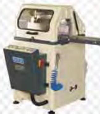
برش یک سر بنوعایت ( برش از پایین ، تیغ ۴۰۰ میلیمتر ، ریل چسبی ۳ متر )
