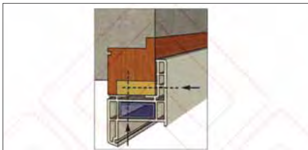
شکل ۸۶ امکان تأمین اتصال بخش‌های کناری و فوقانی پنجره از داخل جان پروفیل یا روی بال داخلی
