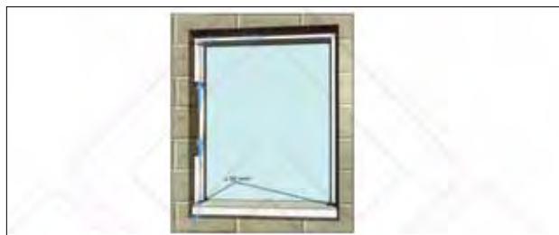
شکل ۱۰۰ جزئیات مسیر و مجاری تهویه پنجره قدیمی
