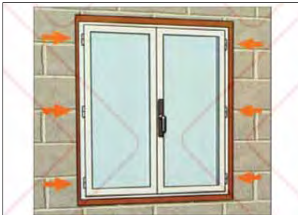
شکل ۸۵ لزوم در نظر گرفتن اتصالات در مجاورت لولاها
