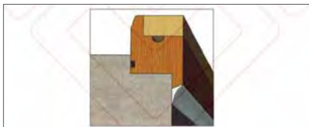
شکل ۹۸ بتانه کاری روکار از داخل درز بین دیوار و چارچوب قدیمی
