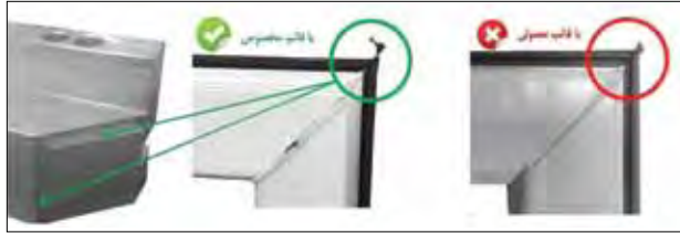
تصویر شماره ۳ نقش قالب جوش در جوش دادن لاستیک در محل جوش
