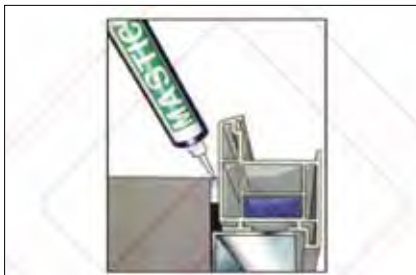
شکل ۶۶ درزبندی پروفیل تحتانی از طرف خارج
