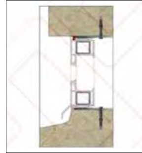
شکل ۷۴ نصب مستقیم پنجره به دیوار توپر بنایی یا بتنی توسط رول بت
