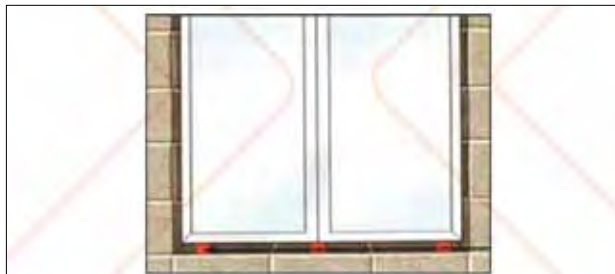
شکل ۴۷ جانمایی لاتن‌های بستر چارچوب
