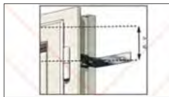
شکل ۴۹ رعایت حداقل فاصله بین نبشی‌های اتصال پنجره به دیوار
