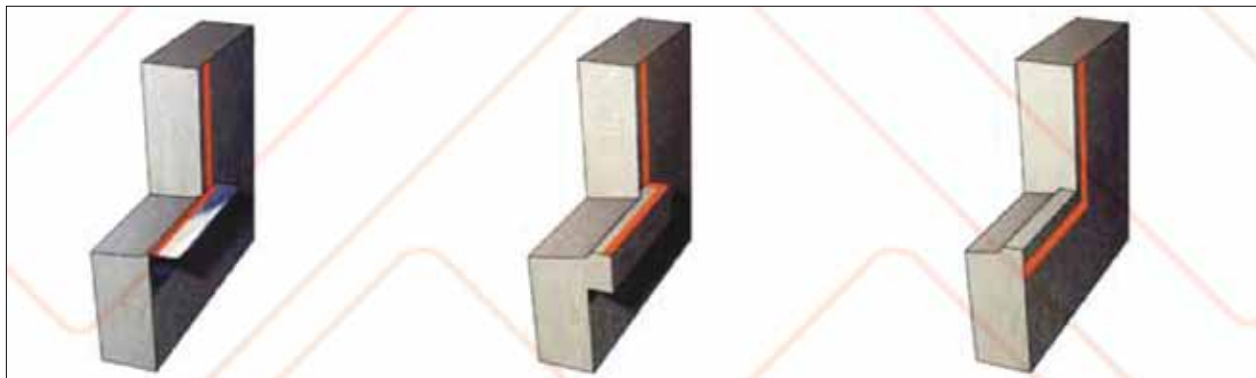
شکل ۲۴ نمونه تکیه‌گاه (زیر پنجره) (فلزی) تکمیلی
