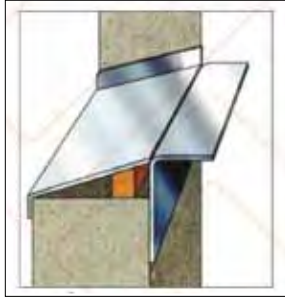
شیب حداقل ۳۵ درصد برای زیر پنجره غیر آلومینیوم
