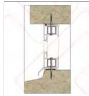
شکل ۷۵ نصب غیر مستقیم پنجره به دیوار توپر بنایی یا بتنی توسط بست و رول پلاگ
