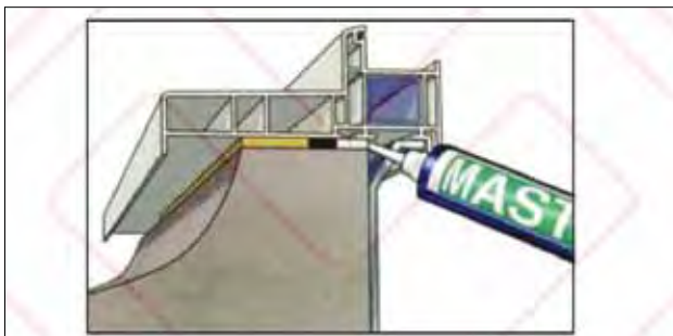
شکل ۶۲ درزبندی زیر پنجره از طرف داخل در صورت استفاده از نبشی دو خم دار
