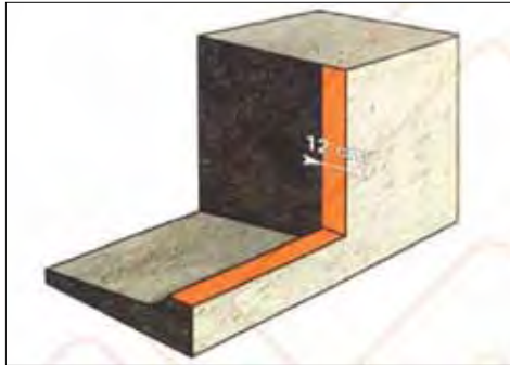
شکل ۳۶ مثال آماده‌سازی بتنی محل نصب پنجره با تکیه‌گاه همباد
