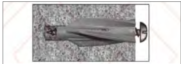
شکل ۴۴ کاربرد رول پلاگ‌های مخصوص بتن سبک
