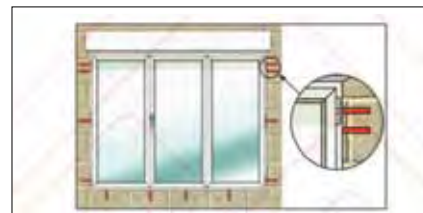
شکل ۵۴ استفاده از نبشی‌های اتصال مضاعف
