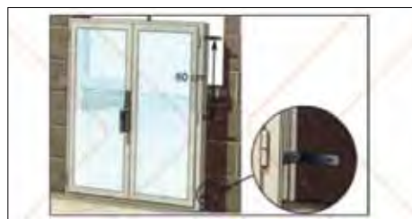
شکل ۴۸ کاربرد نبشی‌های نگهدارنده در نزدیکی اجزای لولایی و نقاط تثبیت چارچوب
