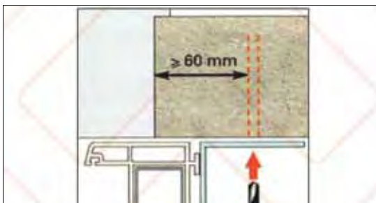
شکل ۵۷ فاصله حداقل پیچ اتصال از گوشه جدار بتنی یا بنایی توپر
