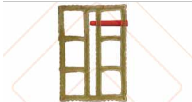
شکل ۴۵ لزوم درگیر شدن رول پلاگ با حداقل دو بدنه بلوک سفالی
