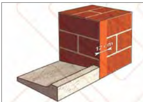
شکل ۳۹ مثال آماده‌سازی محل نصب پنجره با تکیه‌گاه‌های بتنی توکار در یک دیوار آجر نمایان
