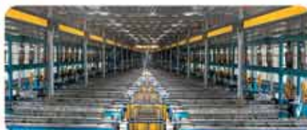
خط تولید پروفیل‌های u.PVC با ۶۵ خط اکستروژن
