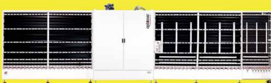
ماشین شستشوی شیشه با ارتفاع ۲۰۰۰ میلیمتر و ۶ برس با گزینه تنظیم اسپیسر
