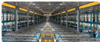
خط تولید پروفیل های u.PVC با ۶۵ خط اکستروژن
