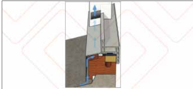
شکل ۱۰۰ جزئیات مسیر و مجاری تهویه پنجره قدیمی
