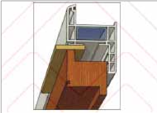
شکل ۸۴ کاربرد لاتن‌های موقت بین قاب پنجره جدید و پنجره قدیمی
