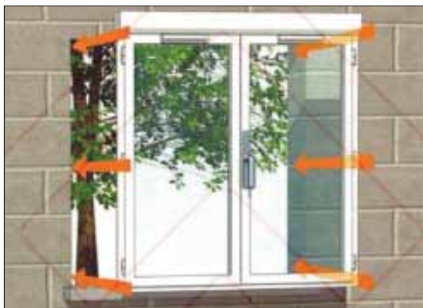
شکل ۲۶ لزوم انطباق پنجره با ابعاد گشودگی، موقعیت قرارگیری و روش نصب
