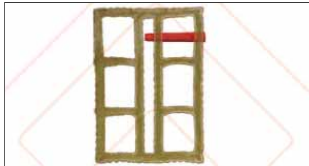
شکل ۴۵ لزوم درگیر شدن رول پلاگ با حداقل دو بدنه بلوک سفالی
