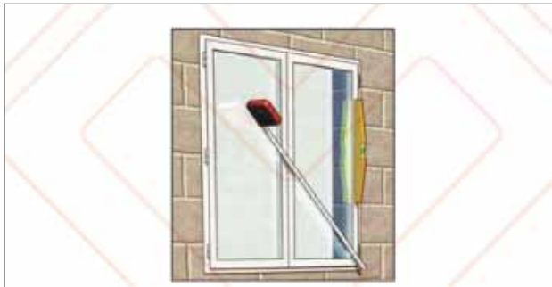
شکل ۶۰ لزوم حصول اطمینان از تساوی قطرها (برای کنترل گونیا بودن پنجره)
