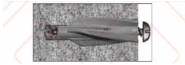
شکل ۴۴ کاربرد رول پلاگ‌های مخصوص بتن سبک
