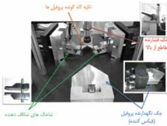
زمان اجرای عملیات پانچ و نحوه قرارگیری صحیح پروفیل و متعلقات دستگاه
