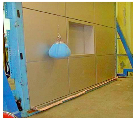
شکل ۳-۶- آزمایش ضربه جسم نرم سنگین روی نمای کامپوزیتی
